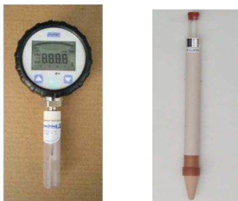
Figura 2. Medidor de vácuo (tensímetro de punção) e tubo de plástico com cápsula na ponta e tampa de borracha (tensiômetros).
