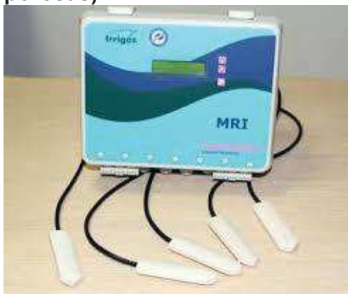
Figura 1. Controlador eletrônico de irrigação e sensores Irrigas® (cápsulas porosas).
