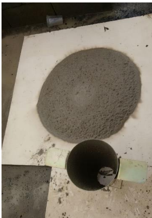
Figura 05 – Ensaio “Slump Flow Test”
