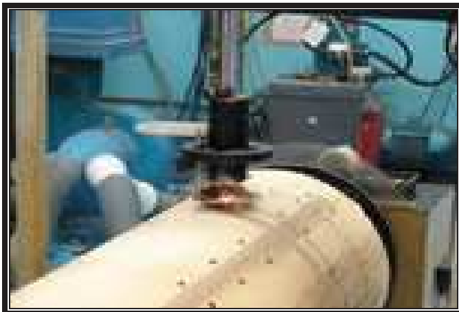
Figura 9 - Corte laser para facas rotativas.
