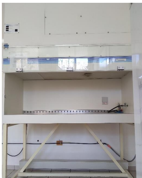
Figura 11 - Cabine de segurança biológica (CSB) laboratório de microbiologia
