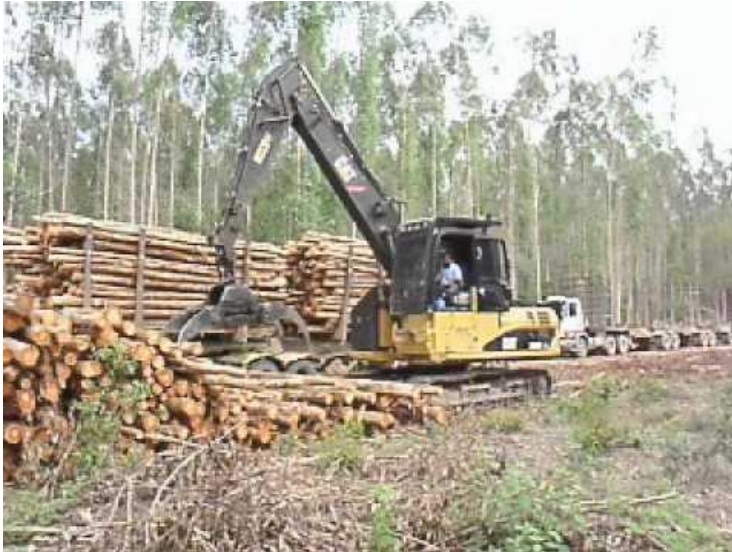
Figura 5 (carregamento feito com escavadeira hidráulica)
