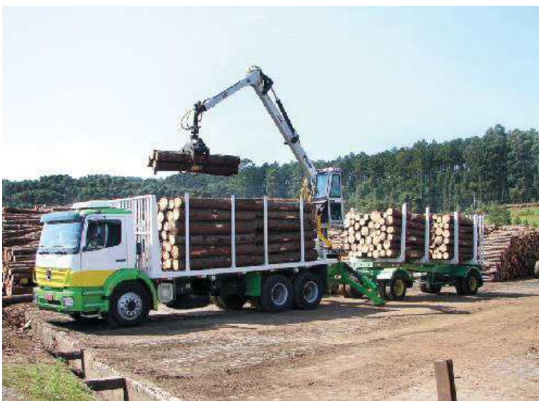
Figura 4 (carregamento feito com equipamento acoplado ao caminhão)
