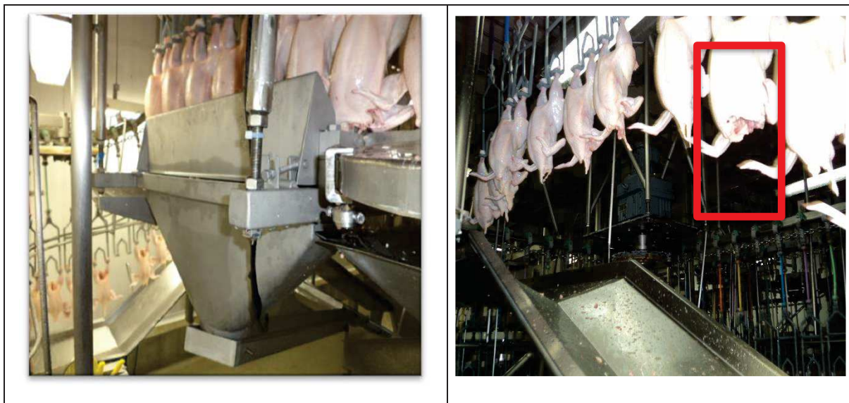
Figura 3 – Foto equipamento de corte da pele do pescoço tipo engrenagem.
