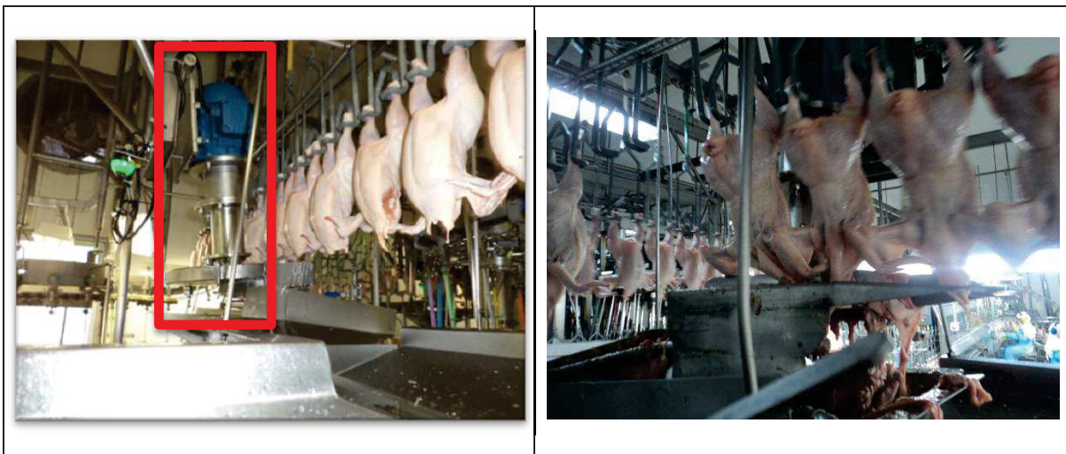
Figura 2 – Foto equipamento de corte da pele do pescoço tipo disco.
