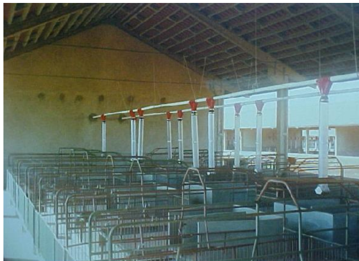
Figura 11 – maternidade utilizando gaiolas e alimentação automática.
